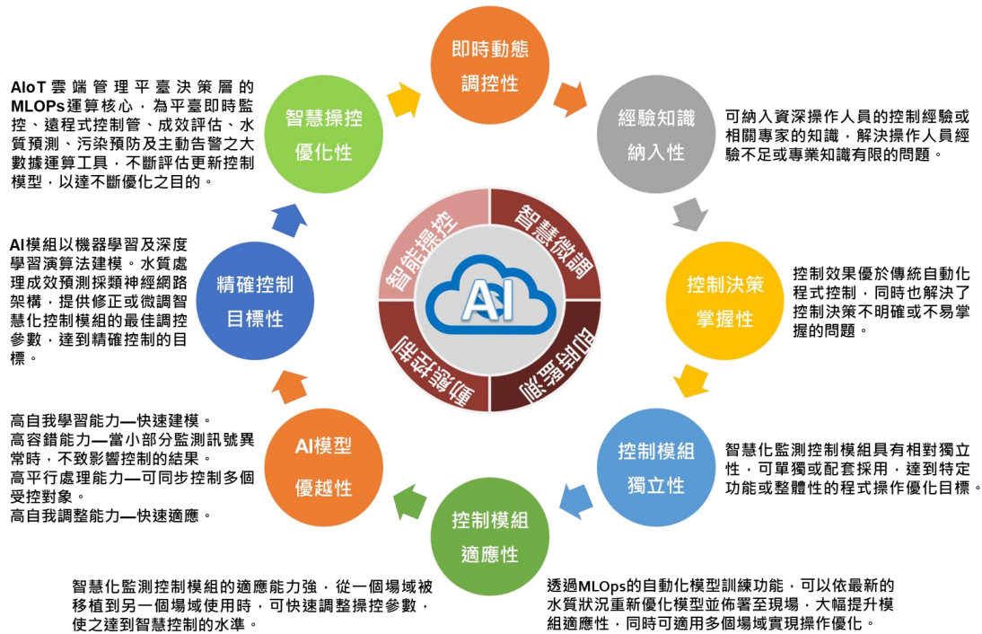
圖 6 程控智聯智能化操控智慧型 (AI) 推論模組特點
