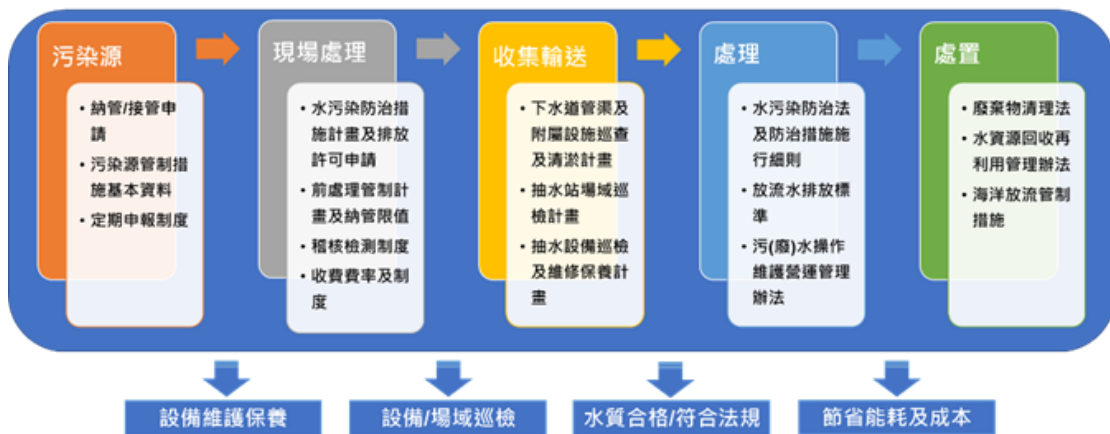
圖 1 污廢水管理系統“系統管理面”需求分析
