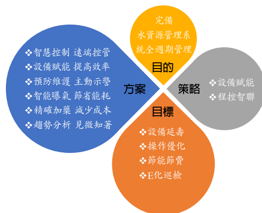
▲圖一 水資源AIoT管理平台功能架構
