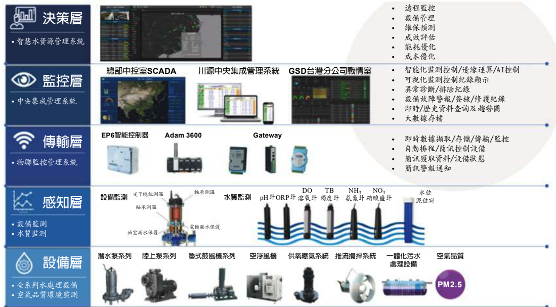
▲圖二 水資源AIoT管理平台物聯網分層功能架構
